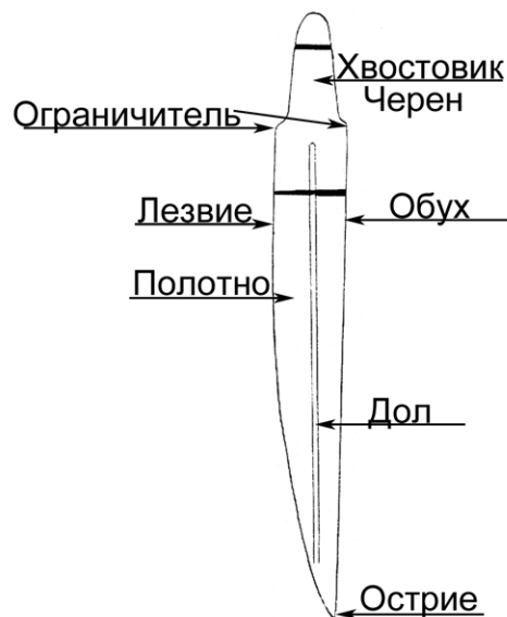
Рис.1. Конструкция должного ножа эпохи Великого переселения народов в Прикамье
